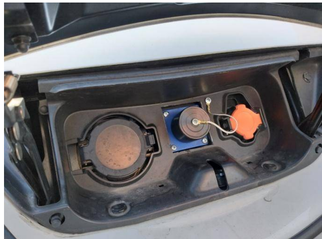
Ladeinfrastruktur des Busses an der Front
